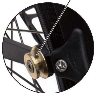
Seitliche Befestigung Side mount
