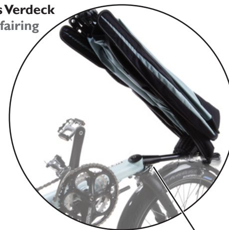
Vordere Befestigung Front mount
