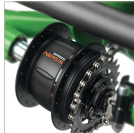
8-Gang Nabenschaltung 8-speed gear hub
