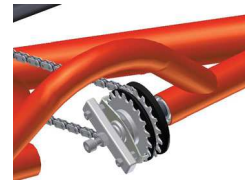
Starrer Antrieb (mit Rutschkupplung) Fixed gear (with sliding hitch)
